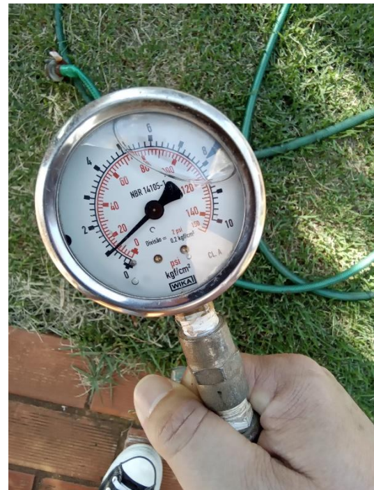
Foto 35 - Hidrômetro P01 – P = 7.00 mca
