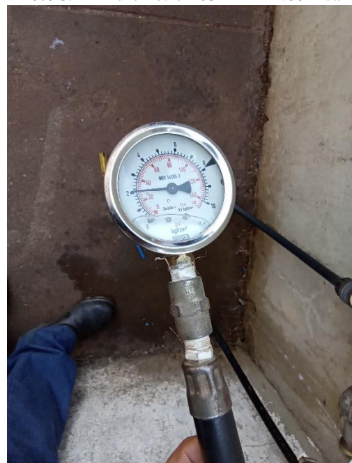
Foto 39 – Hidrômetro P03 - P = 14.00 mca
