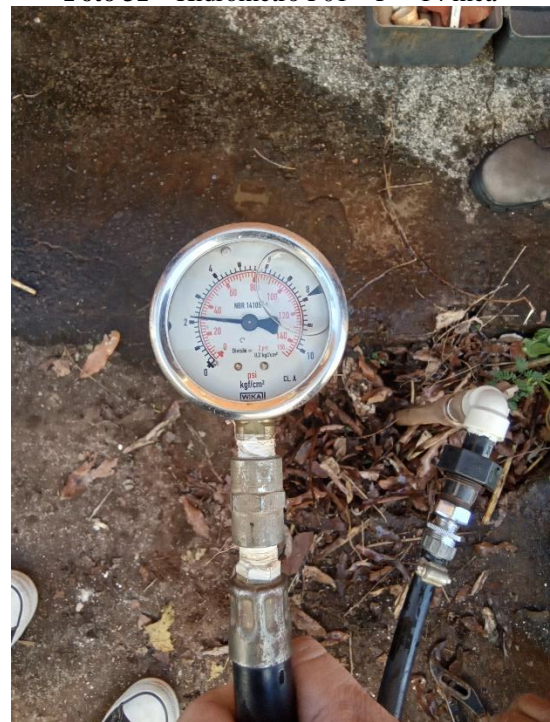
Foto 31 – Hidrômetro P01 – P = 14 mca
