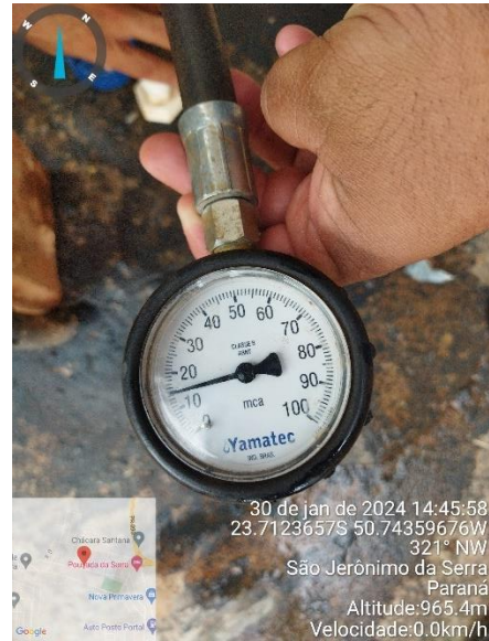
Foto 113 - Medição de pressão do ponto 03
