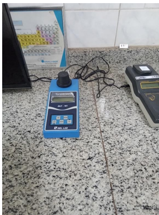
Foto 152 – Equipamentos de aferição de cloro e flúor (sem certificado de calibração)
