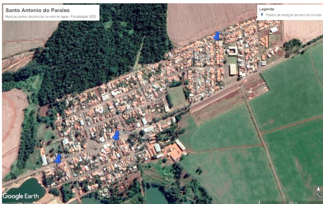
**Figura 2** – Pontos de medição de pressão na rede de distribuição
