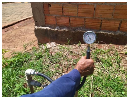
Foto 85: Ponto 02 – Ano de Fabricação 2019. Foto 86: Ponto 02 – Pressão = 58 mca.
