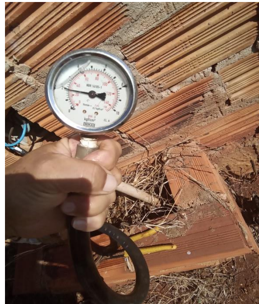
Foto 46 - Medição de pressão P01 (P = 20,6 m.c.a)
