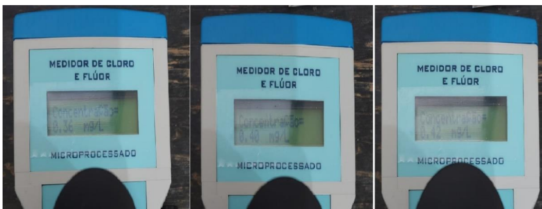
Foto 121 - Medição de cloro do P02
