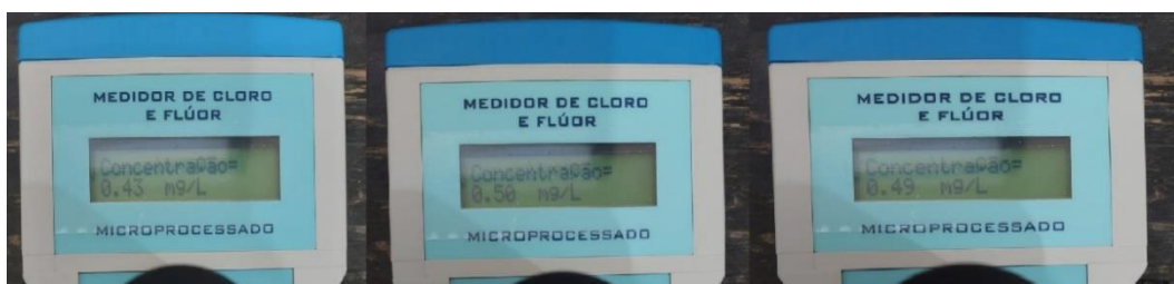
Foto 120 - Medição de cloro do P01
