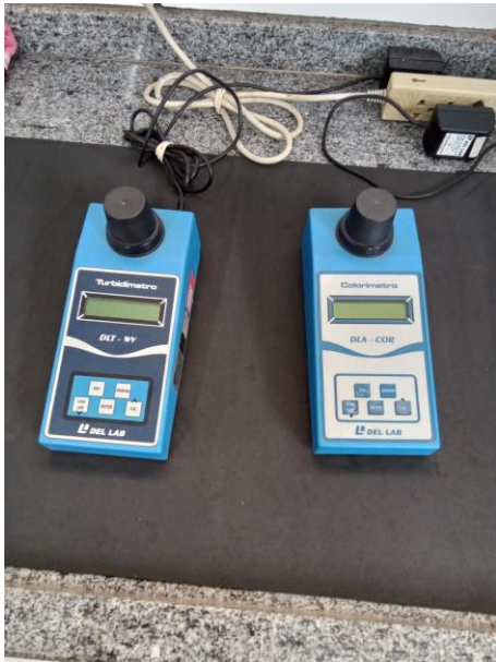
Foto 69 – Equipamentos de aferição de cloro e flúor
