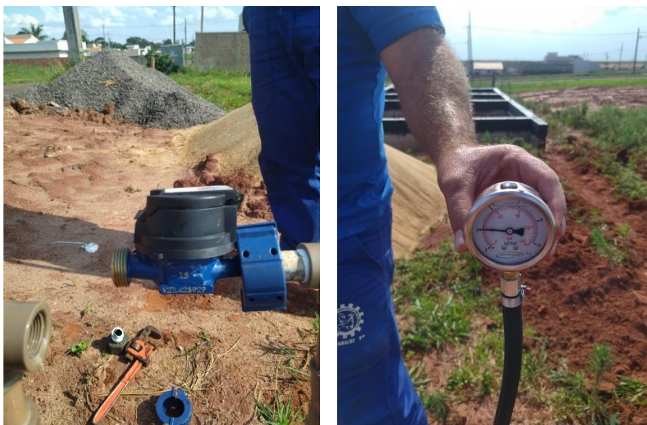
Foto 57: Ponto 3 – Ano de fabricação (2021). Foto 58: Ponto 3 – Pressão = 30 mca.
