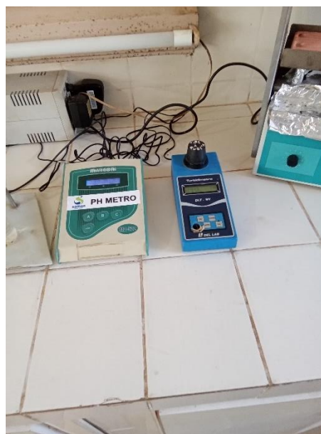
Foto 93 – Equipamentos utilizados no laboratório (phmetro e turbidímetro)
