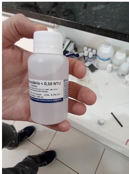
Foto 82 – Padrão de turbidez utilizado nas análises (Vencimento 04/2023)
