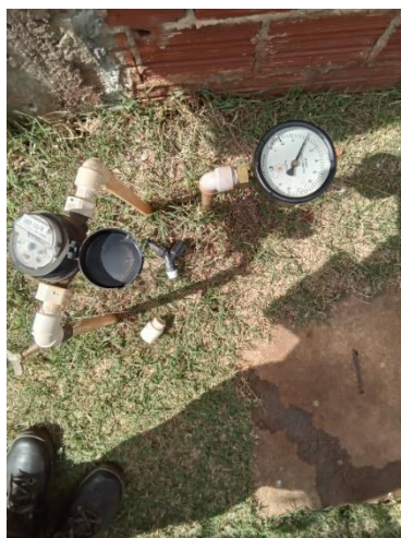
Foto 72 – Medição pressão na rede P01 P = 20.66 mca
