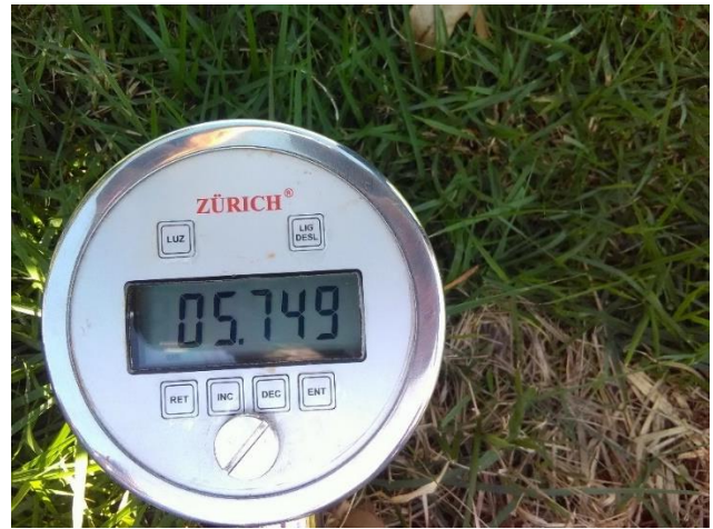
Foto 141 – Medição pressão P01 - P=5,75 \text{ bar} = 58.65 \text{ mca}
