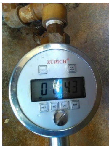
Foto 153 – Medição pressão na rede P05 - P = 1.543 bar = 15.73 mca
