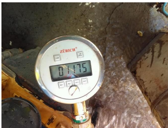
Foto 150 – Medição pressão na rede P04 – P = 1.175 bar = 11.98 mca
