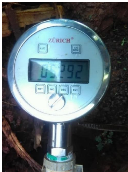
Foto 144 – Medição pressão na rede P02 – P = 5.29 \text{ bar} = 53.96 \text{ mca}
