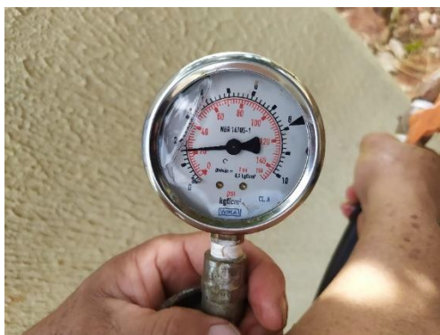
Foto 34 – Medição pressão na rede Rua 7 de Setembro – Capela Mortuária P=23 mca
