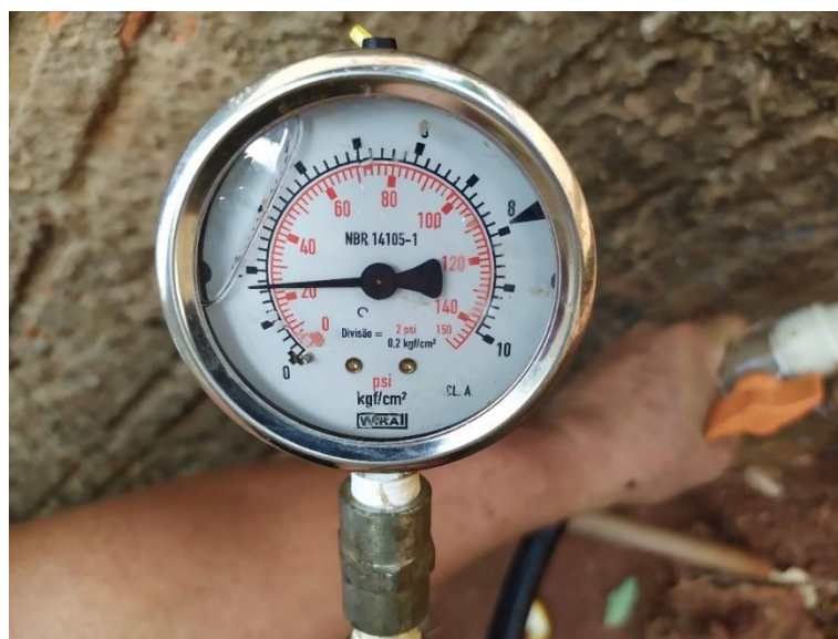
Foto 37 – Medição de pressão na rede hidrômetro Avenida Tiradentes, nº. 16 – P=24 mca
