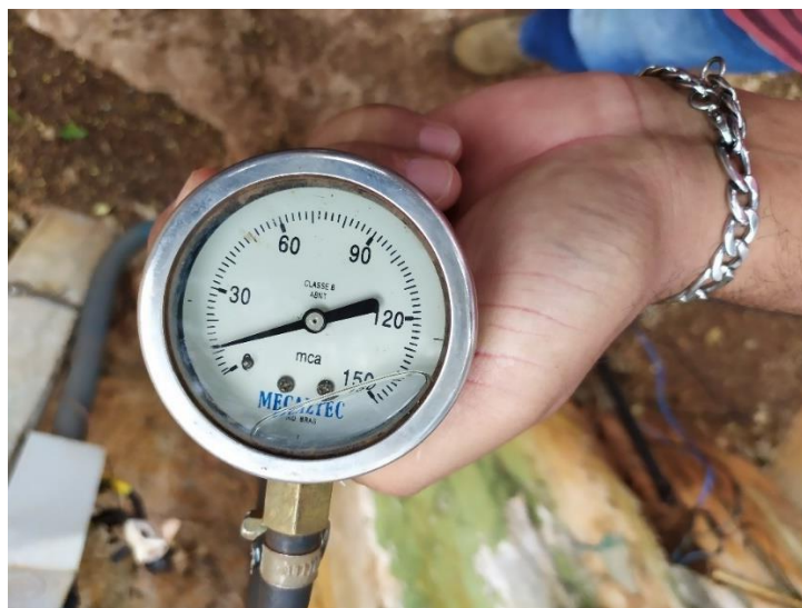
Foto 85 – Medição de pressão na rede Peabiru (Latitude: -23.919232°, -Longitude: - 52.336543°) – P = 9 mca
