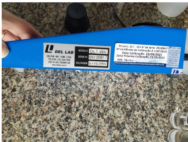
Foto 89 – Calibração do turbidímetro realizado em 23/09/2021
