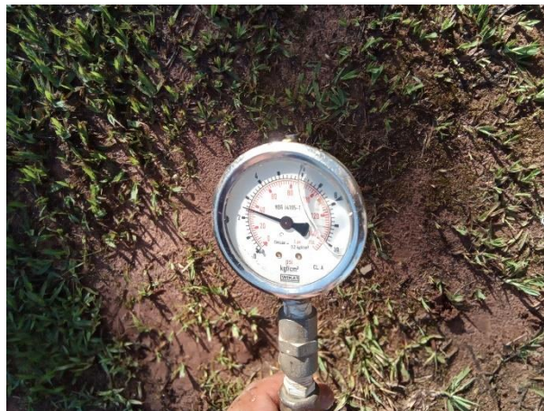
Foto 50 – Hidrômetro P01 – P = 35.00 mca
