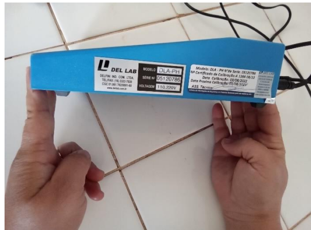
Foto 57 – Vencimento calibração phmetro (03/08/2023)
