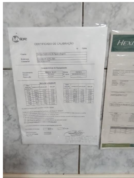
Foto 95 – Certificado de calibração phmetro vencido (23/03/2023)
