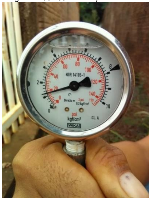
Foto 47 – Medição pressão na rede: Rua José Carneiro da Silva s/n (Latitude: -23.5190657°S e Longitude: -50.7851217° W) - P=17 mca
