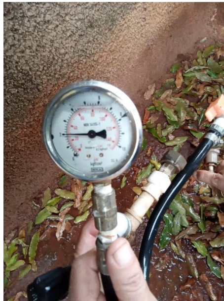
Foto 39 – Hidrômetro P02 – P = 38.00 mca
