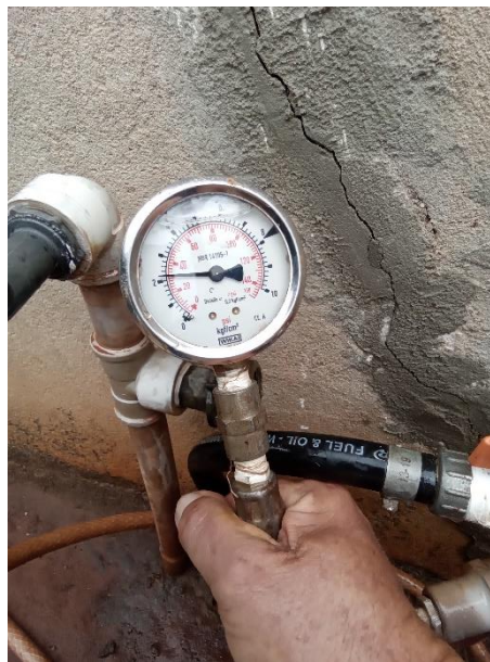
Foto 42 – Hidrômetro P03 – P = 30.00 mca
