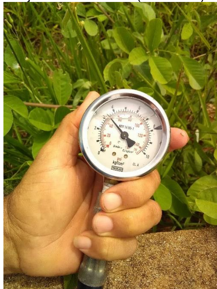
Foto 55 – Medição de pressão na rede: Hidrômetro campo de futebol suíço no Conjunto Oscar Cotrin (P=48 mca)
