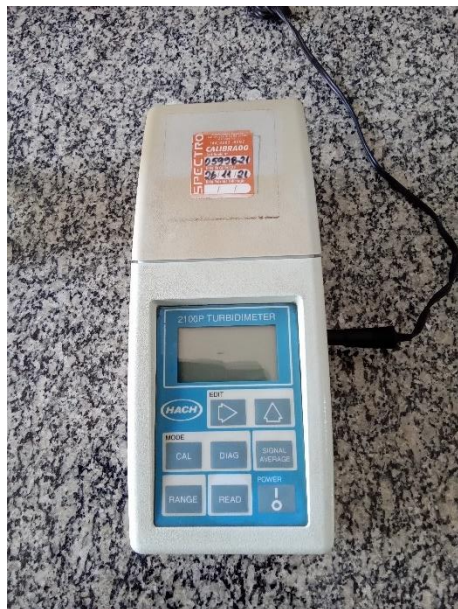
Foto 142 – Turbidímetro calibrado em 26/11/22
