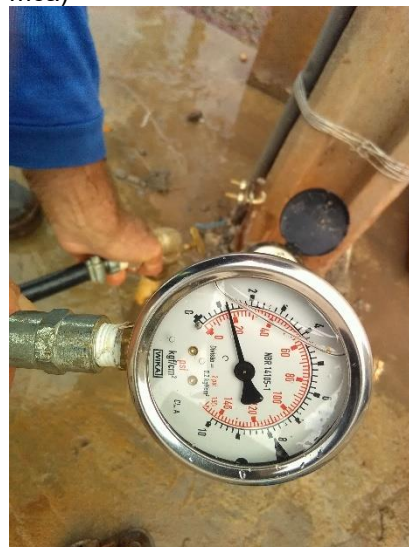
Foto 58 – Medição de pressão na rede: Rua Distrito Federal x Av. Natal Bersanete (Latitude: 23° 3'17.64"S Longitude 51° 1'35.94"O (P=18 mca)
