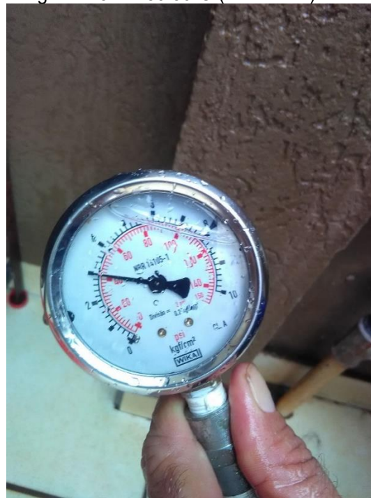
Foto 58 – Medição de pressão na rede: Rua Distrito Federal x Av. Natal Bersanete (Latitude: 23° 3'17.64"S Longitude 51° 1'35.94"O (P=18 mca)
