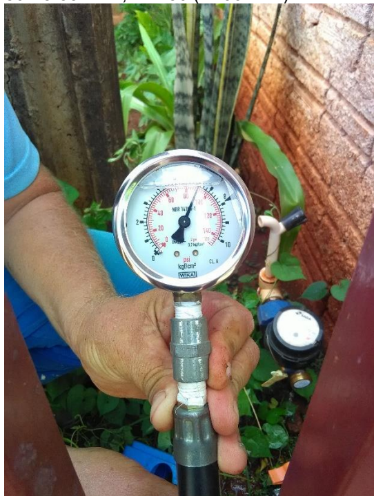
Foto 36 – Medição pressão na rede: Rua Iguazu (Latitude: 23°17'55.75"S e Longitude 50°18'38.7" W, nº 150 (P=90 mca)
