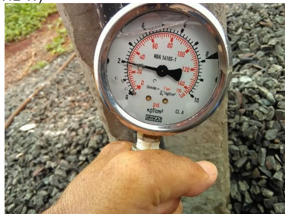
Foto 50 – Medição de pressão na rede: Rua Orival Mangolin, nº. 133 – P=38 mca(23° 42'49.4"S; 51° 38'38.12"W)
