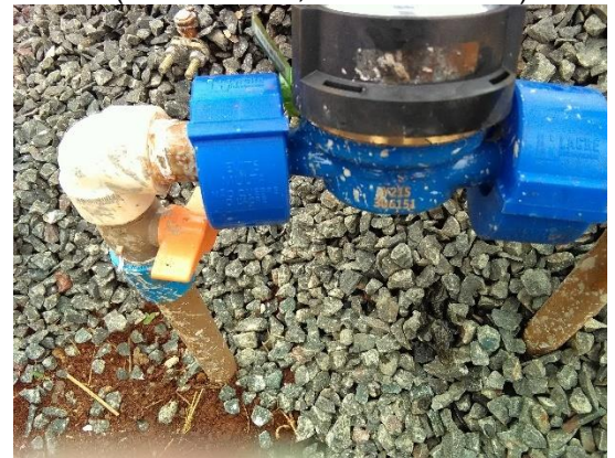
Foto 50 – Medição de pressão na rede: Rua Orival Mangolin, nº. 133 – P=38 mca(23° 42'49.4"S; 51° 38'38.12"W)
