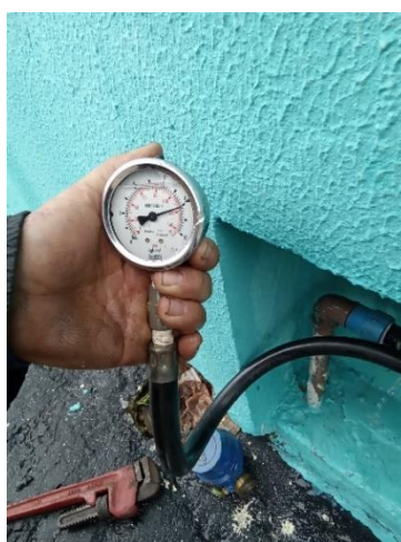
Foto 144 – Medição pressão na rede P02 – P = 114 mca
