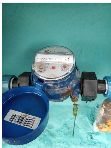
Foto 144 – Medição pressão na rede P02 – P = 114 mca
